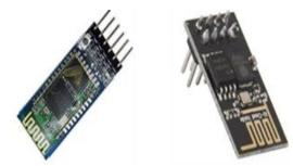
Fig. 7: (a). Bluetooth module (b). Wi-Fi module
