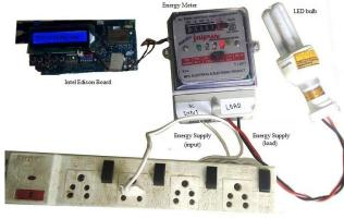
Fig. 2: Smart Energy Meter Prototype
