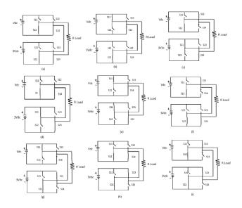
**Fig. 2:** Trinary DC fed MLI operation modes : (a) 0 (b) Vdc (c) 2Vdc (d) 3Vdc (e) 4 Vdc (f) –Vdc (g) -2Vdc (h) -3Vdc (i) -4Vdc
