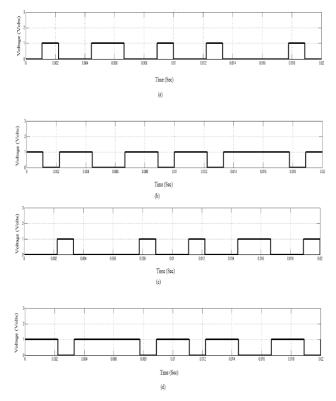
**Fig. 4:** switching signal for Upper Inverter (a) SW11 (b) SW12 (c) SW13 (d) SW14
