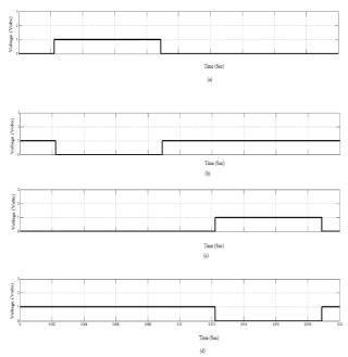
Fig. 5: Switching signal for Lower Inverter (a) SW11 (b) SW12 (c) SW13 (d) SW14
