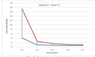
Fig. 5. e2edelay versus Bandwidth
