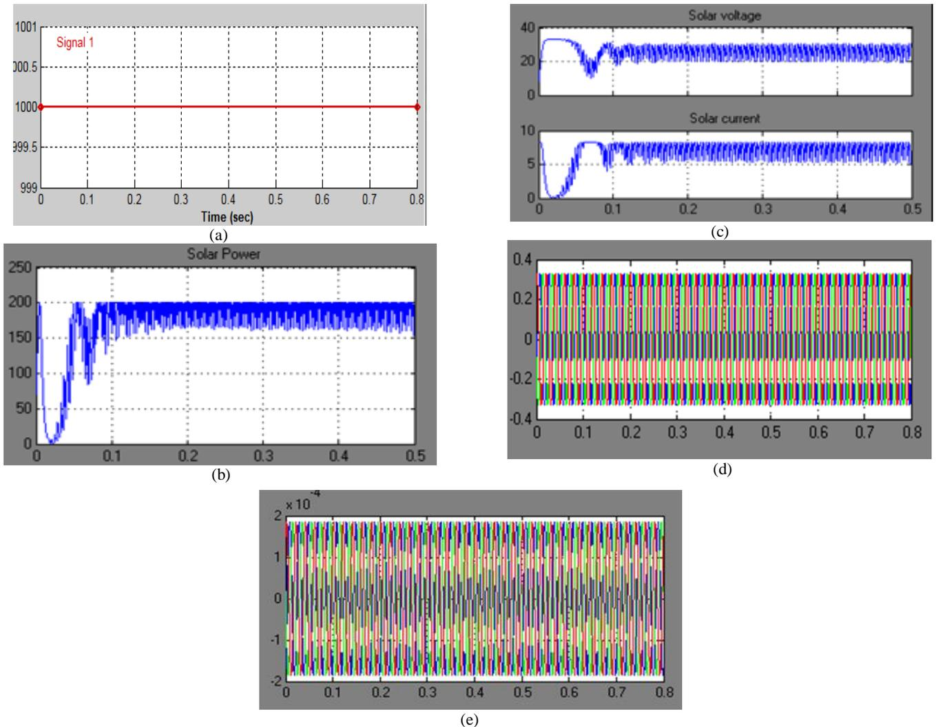
Fig. 7.: (a) solar insolation (b)  $P_{PV}$  (c)  $V_{PV}$ ,  $I_{PV}$  (d)  $V_{Grid}$  (e)  $I_{Grid}$
