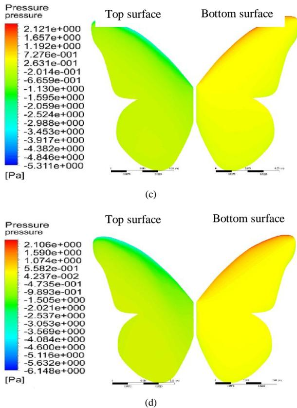
Fig. 6: Pressure contour for different AoA (a) 4°, (b) 6°, (c) 8°, (d) 10°
