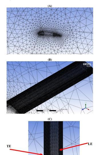
Fig. 3.6: Meshing A) Side View B) Isometric View C) Top View.
