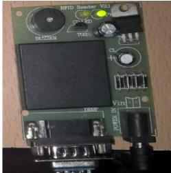
Fig. 3: RFID Reader Module
