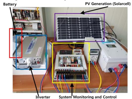
Fig. 1. Prototype.
