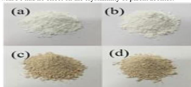
**Figure 1.** Synthesized zeolites (a) Ze-A, (b) Ze-Y, (c) Ze-Fe-A, and (d) Ze-Fe-Y.
