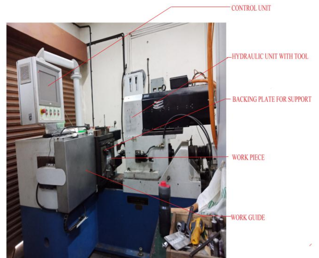
Fig. 8: ETA 3 axis Friction Stir Welding machine
