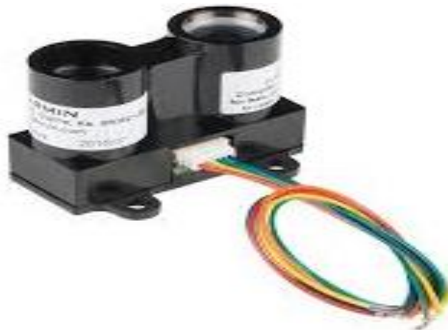
Fig. 2: Lidar Lite v3 Module.
